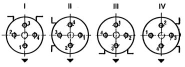
Stellung des Luftanschlusses zur Befestigung.
